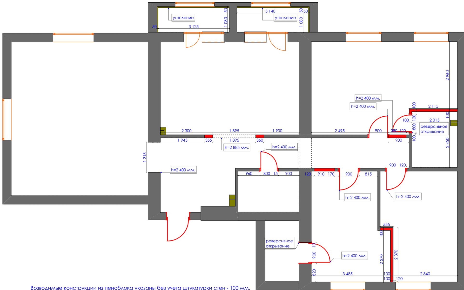
Возводимые конструкции из пеноблока указаны без учета штукатурки стен - 100 мм.
